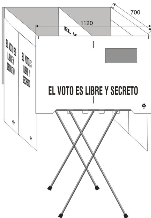
○ Patas tabulares tipo tijera integradas con las cuatro extensiones en un buen estado, es decir que no se encuentren rotas, oxidadas o dobladas.
