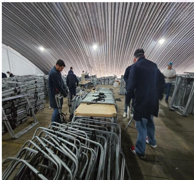
Fotografía 4. Personal de la DEOE y comisionado realizando tareas de revisión, limpieza y mantenimiento de patas tubulares de cancel electoral.
